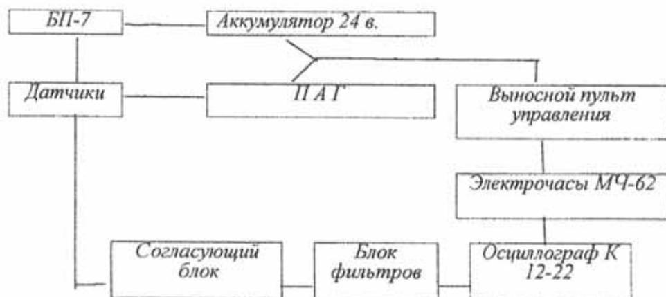
Рисунок 6. Блок-схема измерительной системы регистрации параметров движения.
