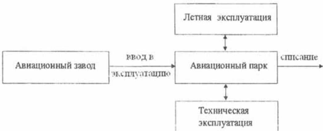
Рисунок 1. Структурная схема модели процесса эксплуатации авиационной техники.
