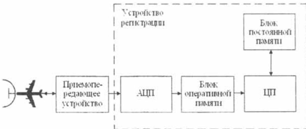
Рисунок 2. Структурная схема устройства регистрации.
