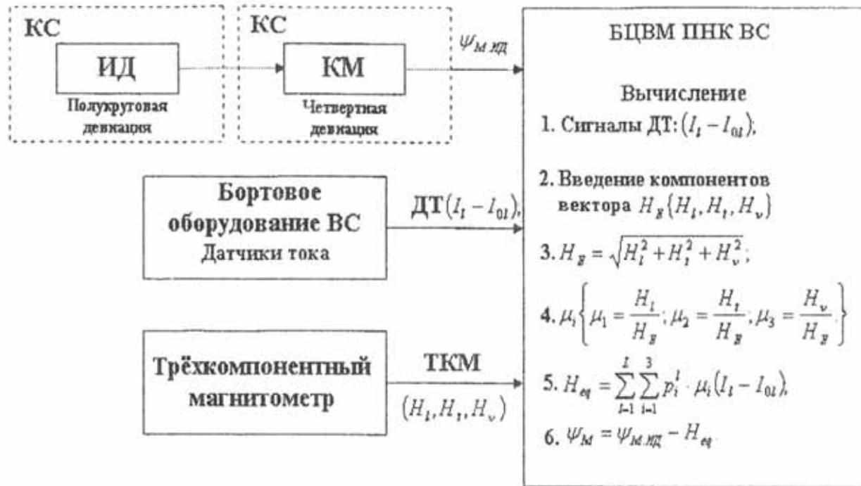
Рисунок 3. Структурная схема алгоритма определения магнитного курса ВС.
