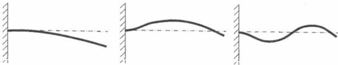
Рисунок 2. Первая, вторая и третья формы изгибных колебаний консоли крыла.
