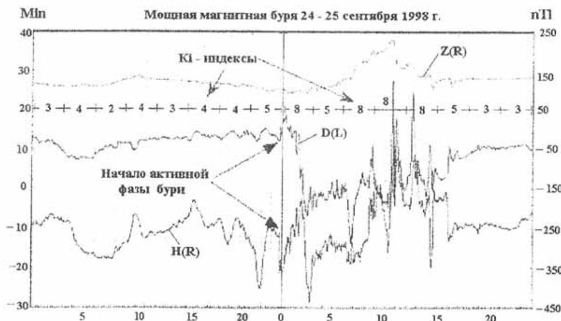
Рисунок 1. Вариации составляющих магнитного поля Земли.  $Z(R)$  – вертикальная составляющая МПЗ;  $H(R)$  – горизонтальная составляющая МПЗ;  $D(L)$  – магнитное склонение.
