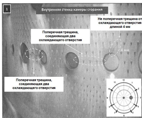
Рисунок 2 – Трещины жаровой трубы
