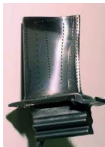
Рисунок 1 – Рабочая лопатка турбины после воздействия высокой температуры
