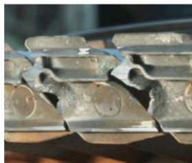
Рисунок 2 – Бандажная полка лопатки после воздействия температуры
