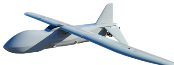
в – самолетного типа с двигателем внутреннего сгорания
