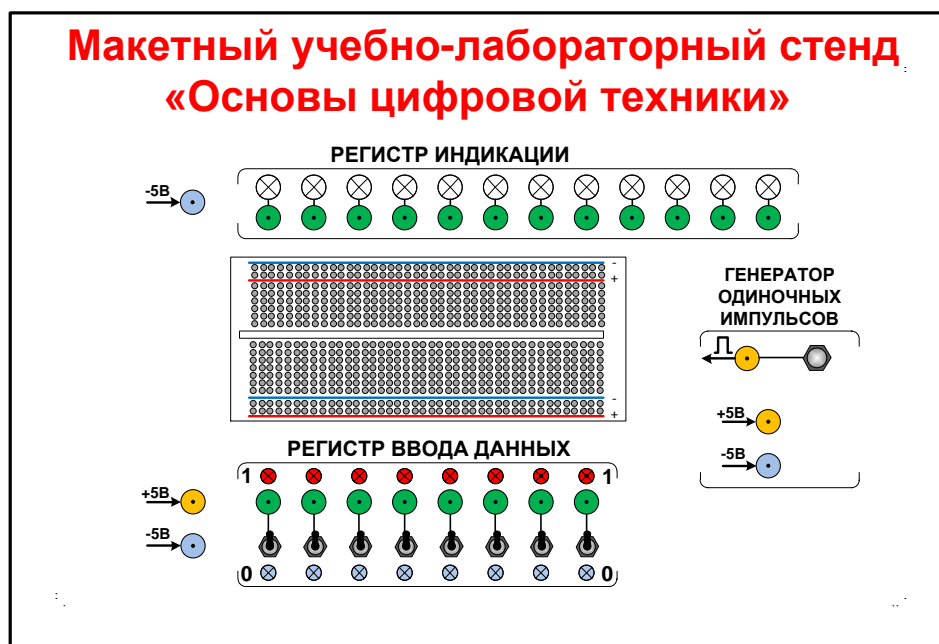
Рисунок 3 – Проект внешнего вида разрабатываемого макетного учебно-лабораторного стенда «Основы цифровой техники»
