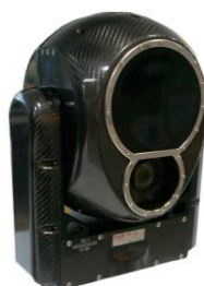
ОЭС ТВ/ИК-диапазонов БПЛА самолетного типа с двигателем внутреннего сгорания
