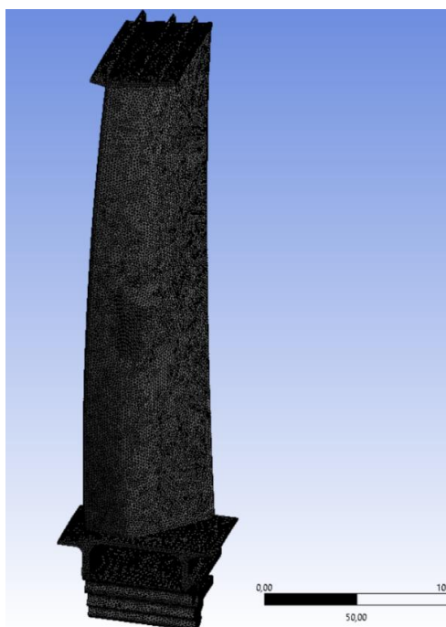
Рисунок 5 – Конечно-элементная сетка рабочей лопатки
