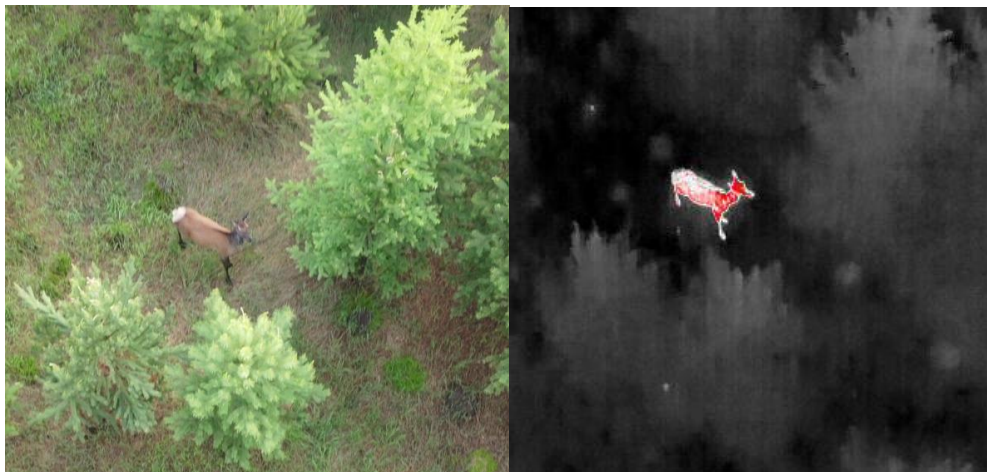
Рисунок 4 – Параллельная съёмка самки благородного оленя на термальную камеру и камеру видимого спектра
