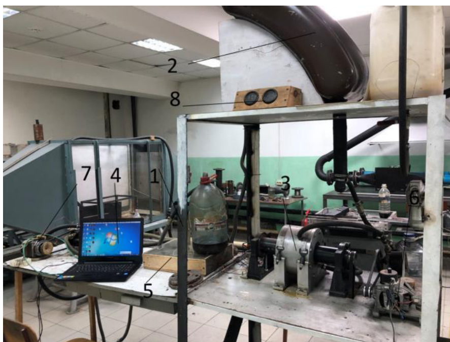
Рисунок 1 – Схема экспериментальной установки: 1 – станина; 2 – бак; 3 – объект исследования; 4 – ноутбук с ПО ZetLab; 5 – цифровые измерительные модули ZET7121; 6 – нагнетающий насос; 7 – откачивающий насос; 8 – указатели давления и температуры масла
