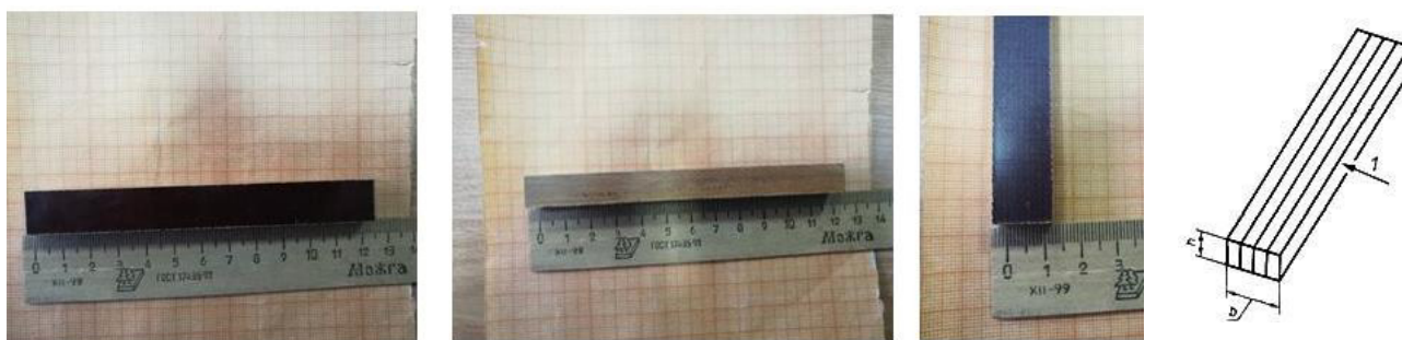
Рисунок 5 – Размеры образцов и схема обозначений, описывающих направление удара: 1 – направление удара; b – ширина образца; h – толщина образца
