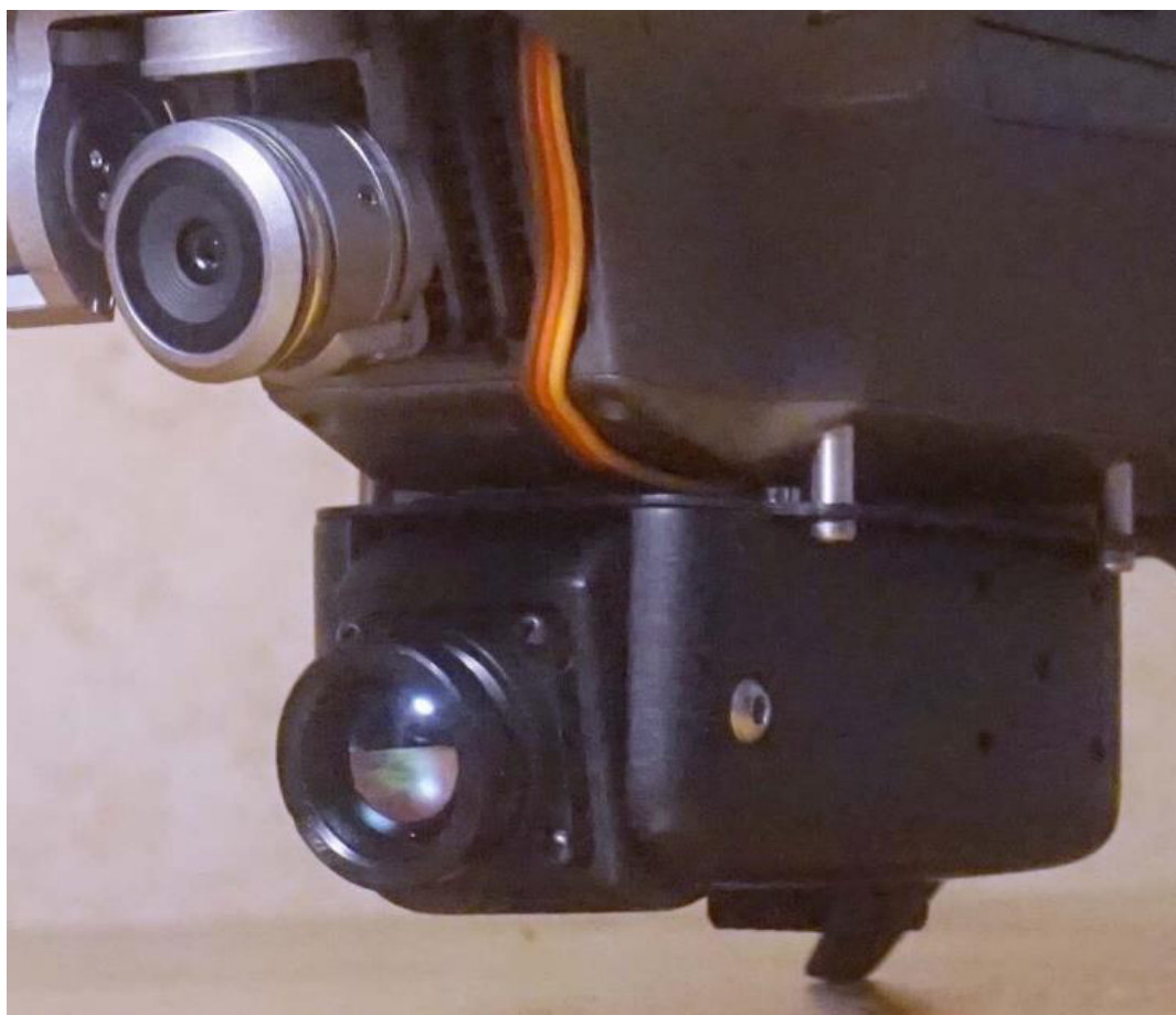
Рисунок 4 – ТВ и ИК камеры, установленные на БПЛА
