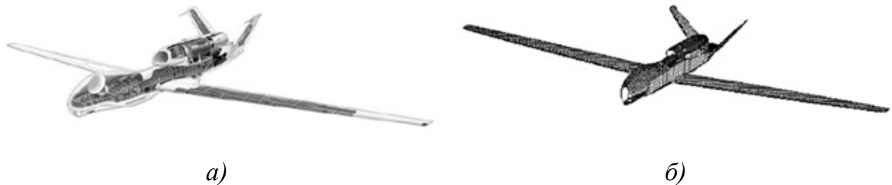
Рисунок 1 – RQ-4B Global Hawk: а – компоновочная схема; б – модель
