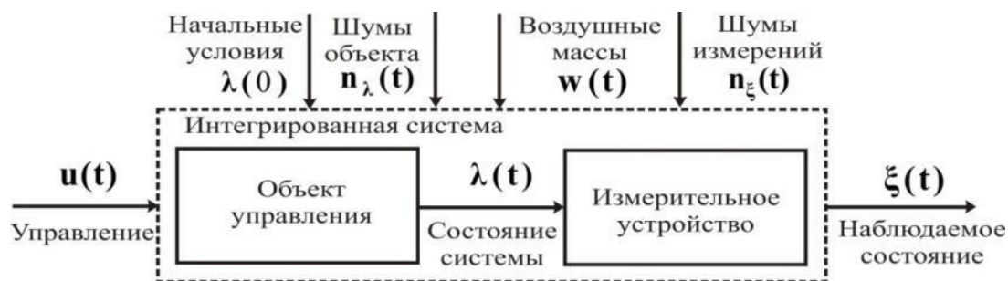
Рисунок 2 – Обобщенная структура динамической системы: u(t) – вектор сигналов управления ВС элементами ИСН, измерительными системами и устройствами; n_{\xi}(t) – вектор возмущений, определяющих ошибки измерителей; n_{\lambda}(t) – вектор возмущений, действующих на ВС и его системы; \lambda(t) – вектор состояния, с помощью которого задается положение ВС или параметры навигационных измерителей
