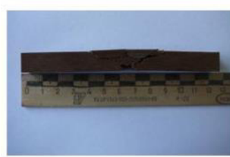
Рисунок 7 – Образцы после испытаний при разных температурах: а – при температуре 0 °С; б – при температуре минус 10 °С; в – при температуре минус 60 °С
