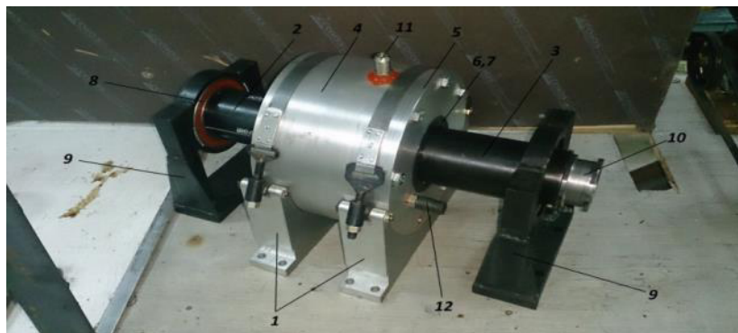
Рисунок 3 – Основной узел экспериментальной установки: 1 – подставки; 2 – ведомый вал; 3 – ведущий вал; 4 – корпус; 5 – крышка; 6 – поддерживающий подшипник; 7 – сальник; 8 – удерживающий подшипник; 9 – опоры; 10 – шкив ременного привода; 11 – штуцер подачи масла; 12 – штуцер отвода масла
