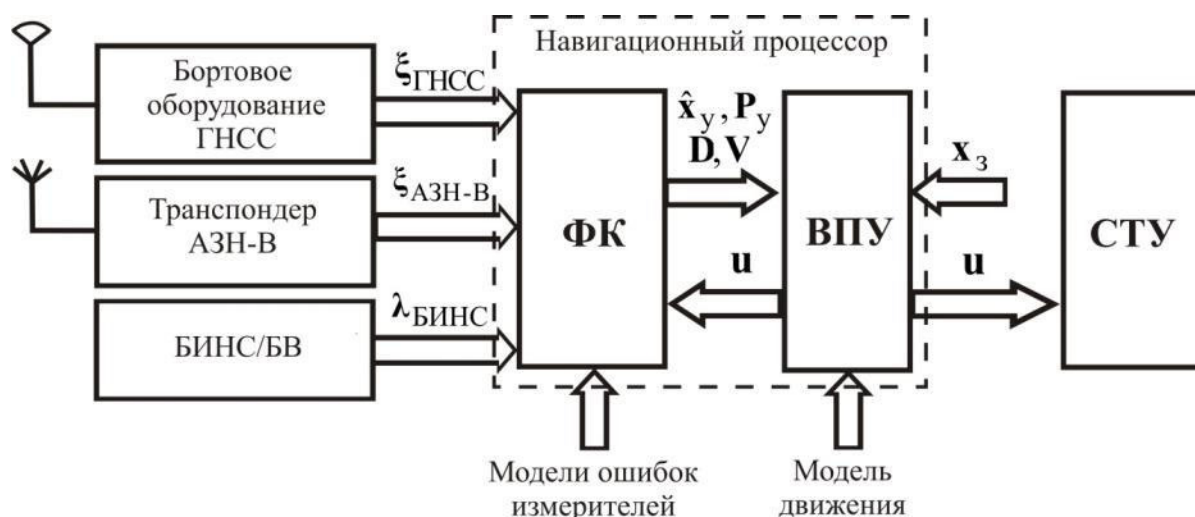
Рисунок 3 – Структура предлагаемой ИСН: ФК – фильтр Калмана; СТУ – система траекторного управления; ВПУ – вычислитель параметров управления
