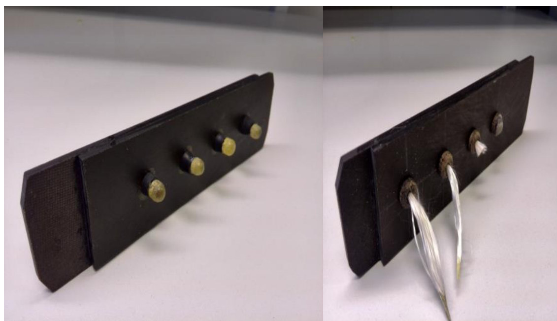
Рисунок 7 – Натурное исполнения технологической последовательности нахлесточного соединения углекомпозитной конструкции перспективной заклепкой из ПКМ: а – образование замыкающей головки; б – образование закладной головки
