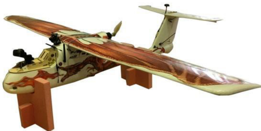
Рисунок 1 – Беспилотный поисковый летательный аппарат длительного полета с комплектом оптико-электронного оборудования
