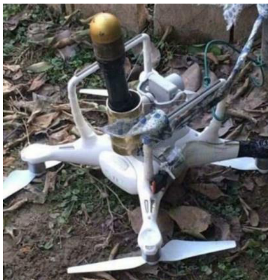
Рисунок 2 – «DJI Phantom 4» со сбрасываемым взрывным устройством
